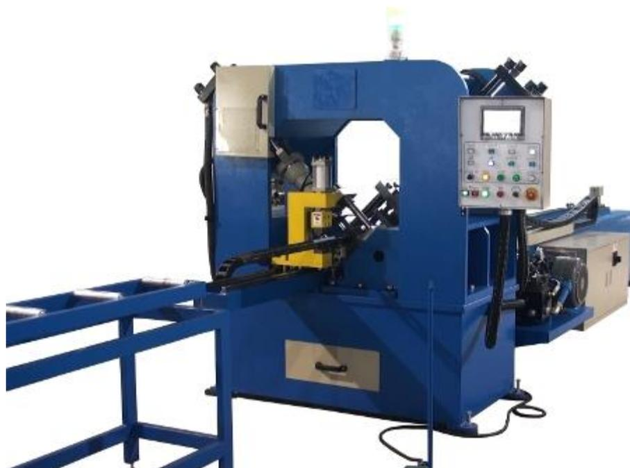
Станки данной серии предназначены для бездеформационной одно или двухсторонней пробивки отверстий в угловых профилях из черных и цветных металлов и сплавов.
